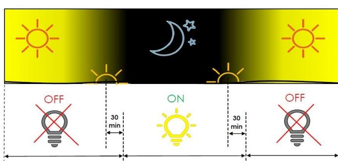
Il funzionamento alla presenza di illuminazione solare oltre ad essere inutile e sprecare energia riduce la durata del prodotto a causa dell'elevato riscaldamento che viene a determinarsi sui LED sollecitati dal calore. Si suggerisce di automatizzare il funzionamento degli apparecchi.
